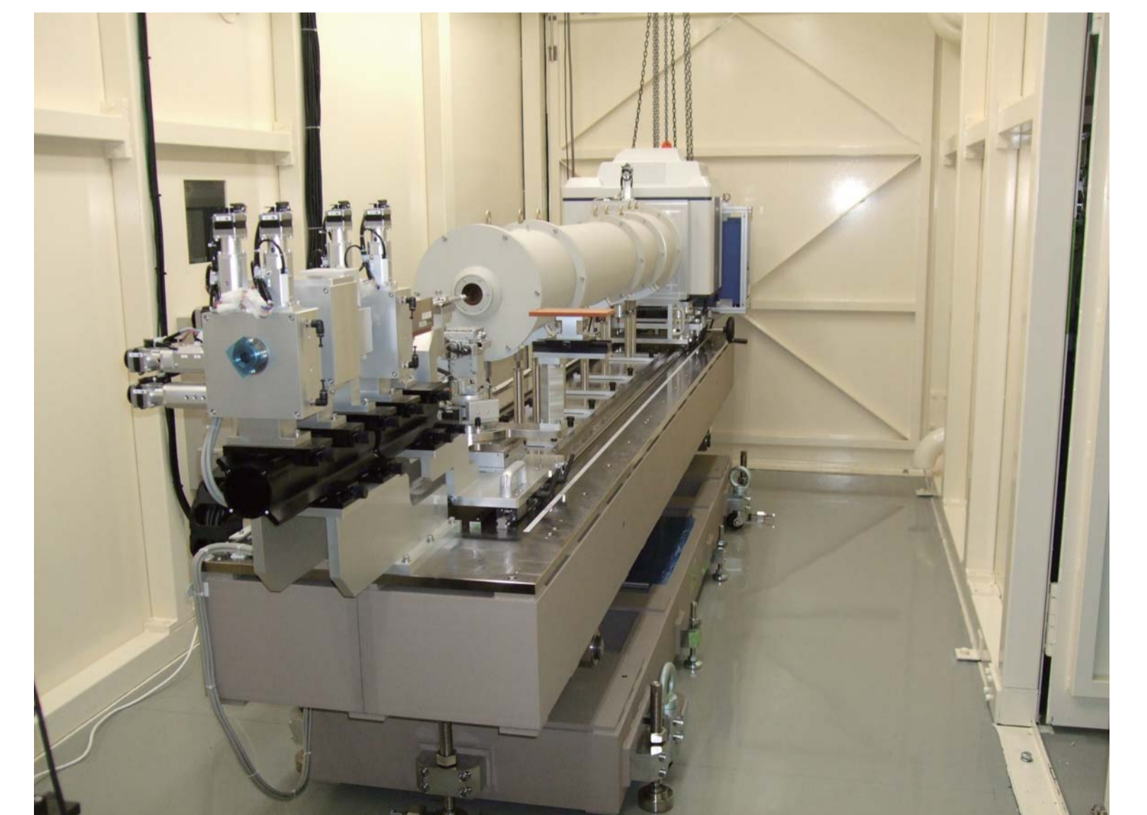
SAXS セットアップ (カメラ長 2500mm)
